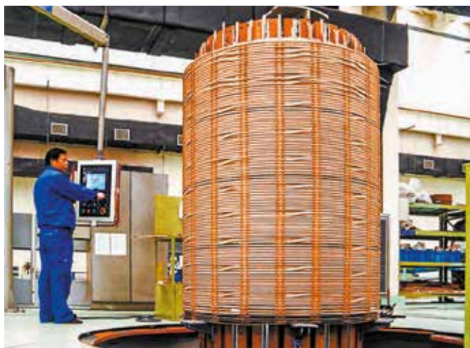
Вертикально-намоточный станок с устройством натяжения и функциями преобразования частоты и регулирования скорости
