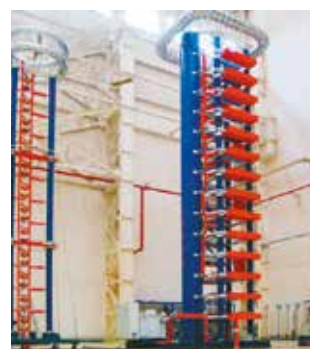
Генератор импульсного напряжения
