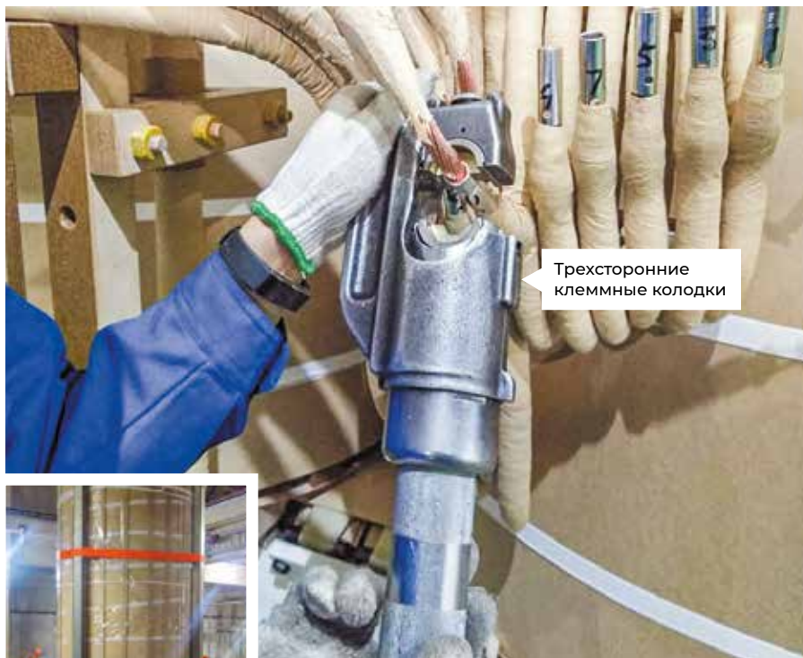
Предотвращение попадания посторонних частиц в течение всего процесса подключения проводов к активной части
