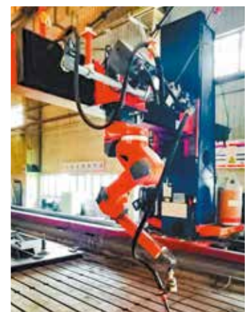
Сварочный робот для изготовления стенок масляного бака
