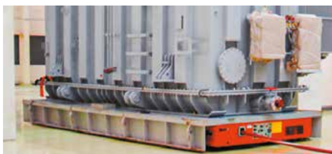
Платформа на воздушной подушке грузоподъемностью 260 т
