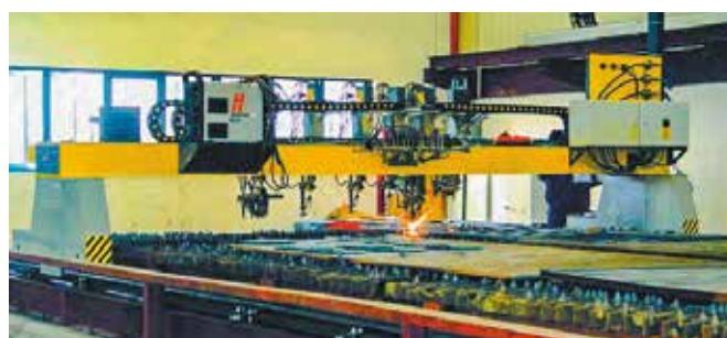
Установка плазменной резки с ЧПУ
