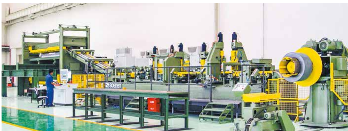
Линия поперечной резки Soenen (Бельгия)
