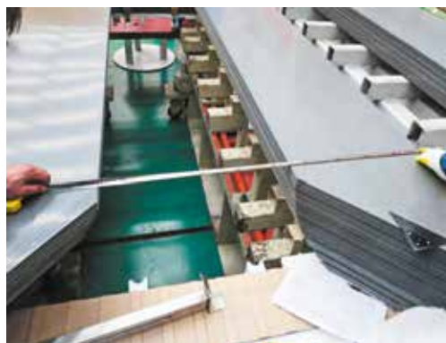
Измерение расстояния между центрами стержней магнитопровода
