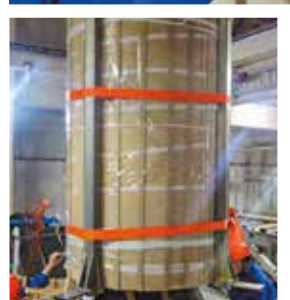
Предотвращение попадания посторонних частиц в течение всего процесса подключения проводов к активной части
