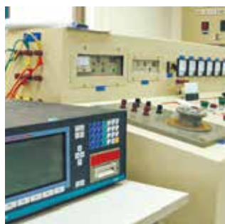
Установка для анализа качества электроэнергии
