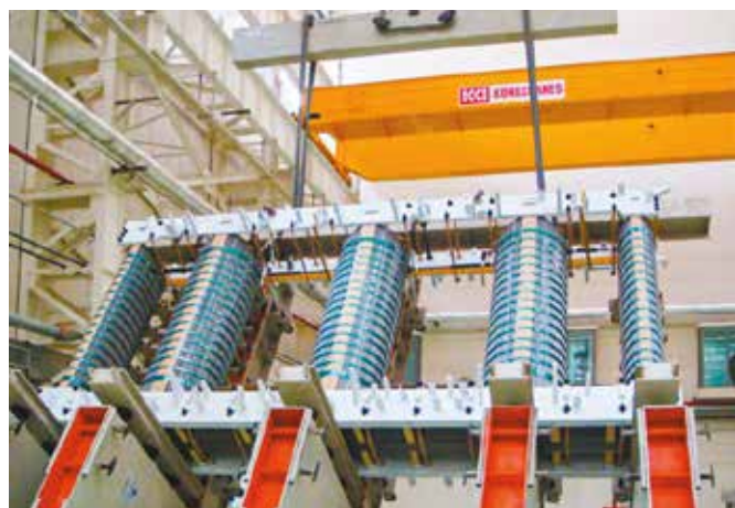
Стенд для сборки и кантования
