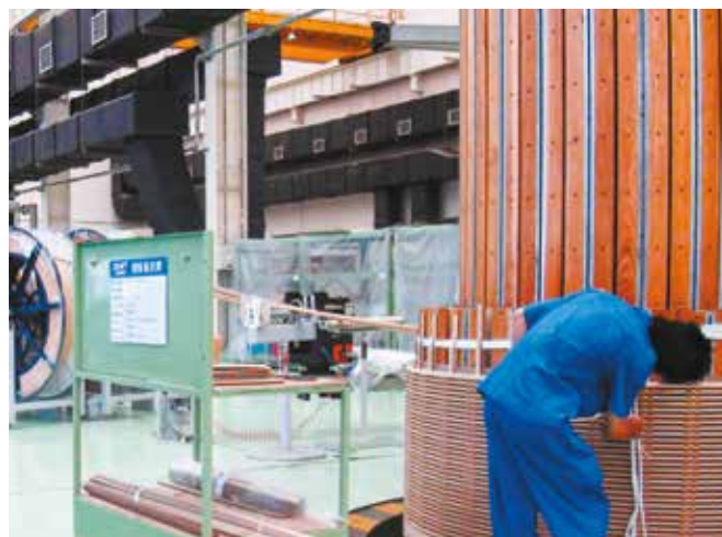
Вертикально-намоточный станок с устройством натяжения и функциями преобразования частоты и регулирования скорости
