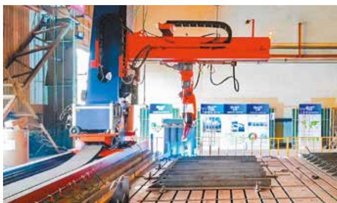
Сварочный робот с платформой
